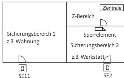
Der Z-Bereich ist in die Zwangsläufigkeit aller Sicherungsbereiche einbezogen, d.h. im Beispiel kann der Sicherungsbereich 1 oder 2 erst extern scharf geschaltet werden, wenn sich die Melder im Z-Bereich in Ruhe befinden und die Tür zum Z-Bereich verschlossen ist.
